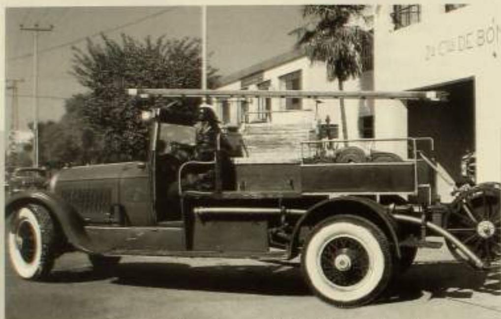
**Auto-bomba Cadillac, de construcción local con motobomba portátil Magirus de 1.000 lpm. 1938. Bomberos de Puente Alto.**
