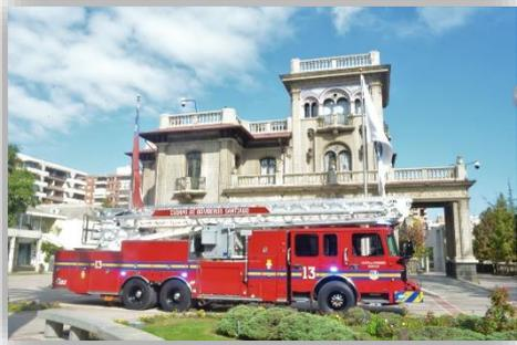
Con carros como el anterior y el Mx13 con una Plataforma articulada de 36 metros con canastillo para cuatro personas, montada sobre un camión Spartan, con capacidad: 300 G. de agua; 60 G. de espuma el CBS se encuentra en condiciones de atender emergencias de gran complejidad.
